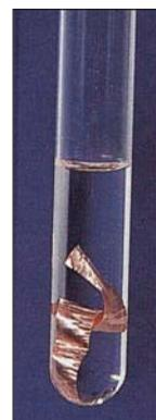
Une solution d'acide chlorhydrique n'a aucune action sur le cuivre.
