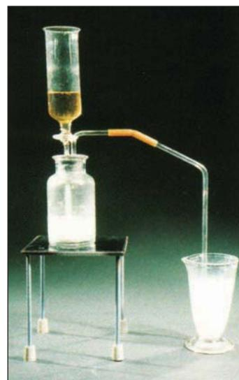
Le calcaire réagit avec une solution d'acide chlorhydrique en dégageant un gaz qui trouble l'eau de chaux : le dioxyde de carbone .
