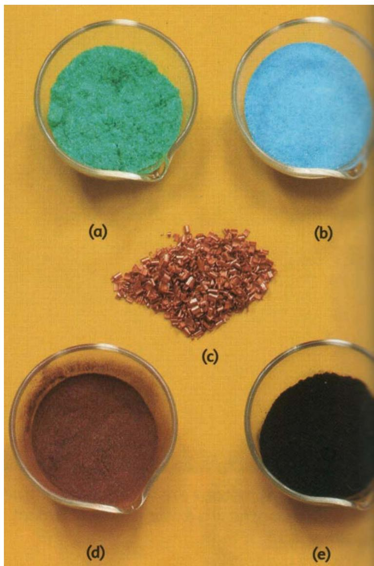
La photo ci-dessus représente des échantillons de chlorure de cuivre (II) (a), de nitrate de cuivre (II) (b), de copeaux de cuivre métallique (c), de cuivre en poudre (d) et d'oxyde de cuivre (II) (e).
