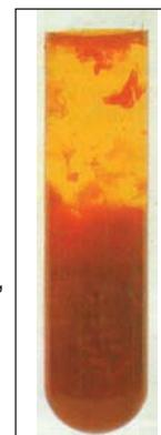
**Le précipité rouille d'hydroxyde de fer (III) révèle la présence d'ions  $OH^-$  dans la solution de potasse.**
