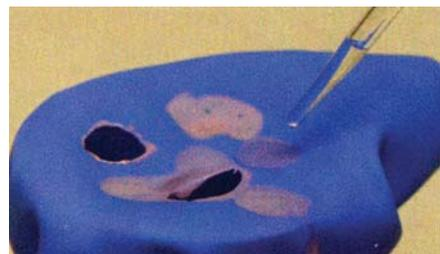
Une goutte d'une solution d'acide chlorhydrique déposée sur un échantillon de blouse en Nylon attaque le tissu : il se décolore et se troue.
