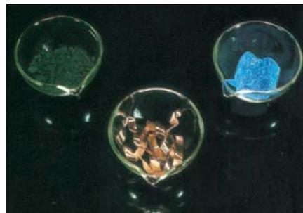
Des échantillons de cuivre, d'oxyde de cuivre (II) et de sulfate de cuivre (II)
