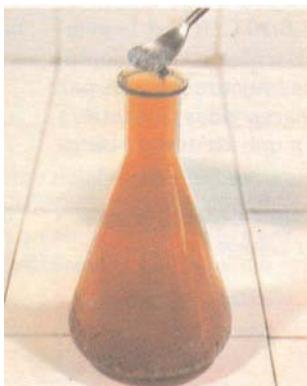
**Réaction du dibrome avec de l'aluminium**
