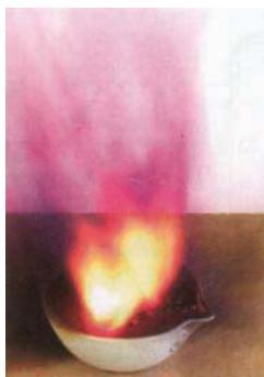
**Réaction du diiode avec de l'aluminium**
