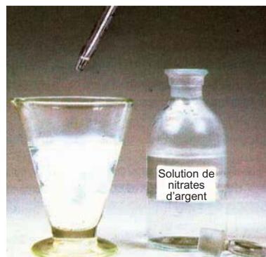
**Une solution d'acide chlorhydrique réagit avec une solution de nitrate d'argent en donnant un précipité blanc de chlorure d'argent.**
